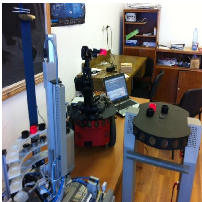
Fig. 16. Linia de mecatronica FESTO MPS-200 deservita de platformele mobile: Pioneer 3-DX (echipata cu manipulatorul Pioneer) si PeopleBot, aceasta neechipata sau echipata cu manipulatorul 6-DOF Cyton 2 Premium P-Series Robot Arm
