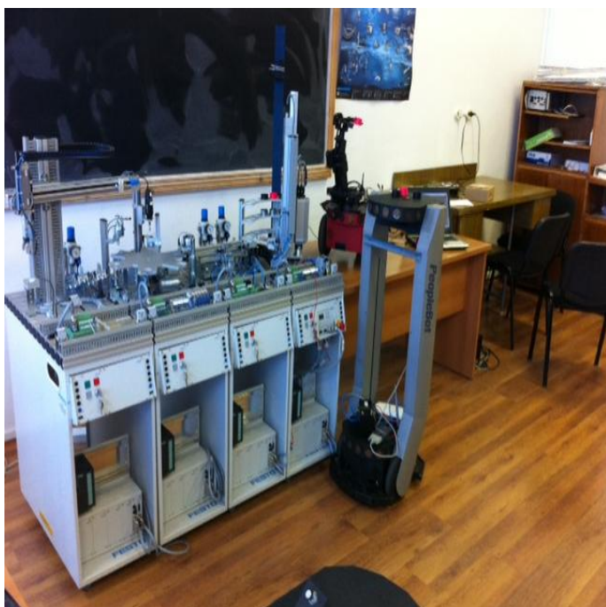
Fig. 16. Linia de mecatronica FESTO MPS-200 deservita de platformele mobile: Pioneer 3-DX (echipata cu manipulatorul Pioneer) si PeopleBot, aceasta neechipata sau echipata cu manipulatorul 6-DOF Cyton 2 Premium P-Series Robot Arm
