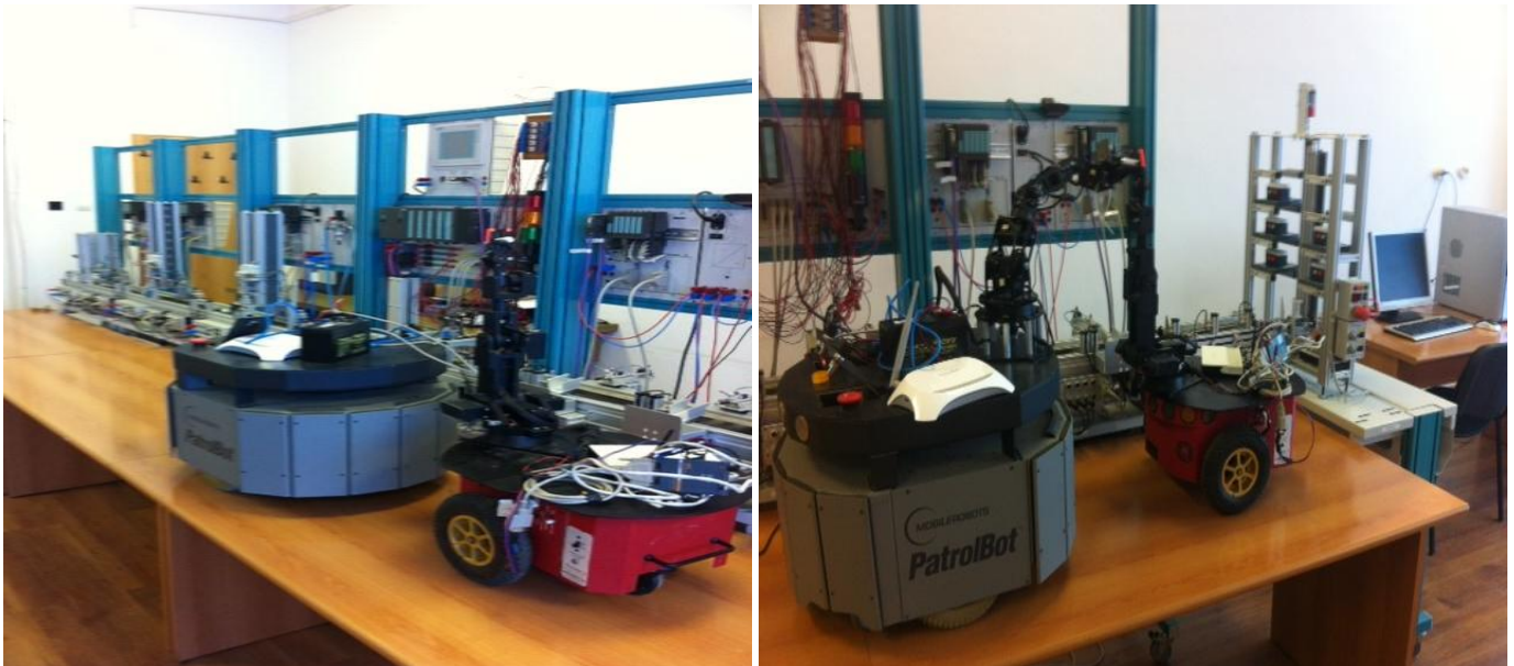
Fig. 14. Linia de mecatronica Hera&Horstman deservita de platformele mobile: Pioneer 3-DX (echipata cu manipulatorul Pioneer) si PatrolBot, aceasta neechipata sau echipata cu manipulatorul 6-DOF Cyton 2 Premium P-Series Robot Arm
