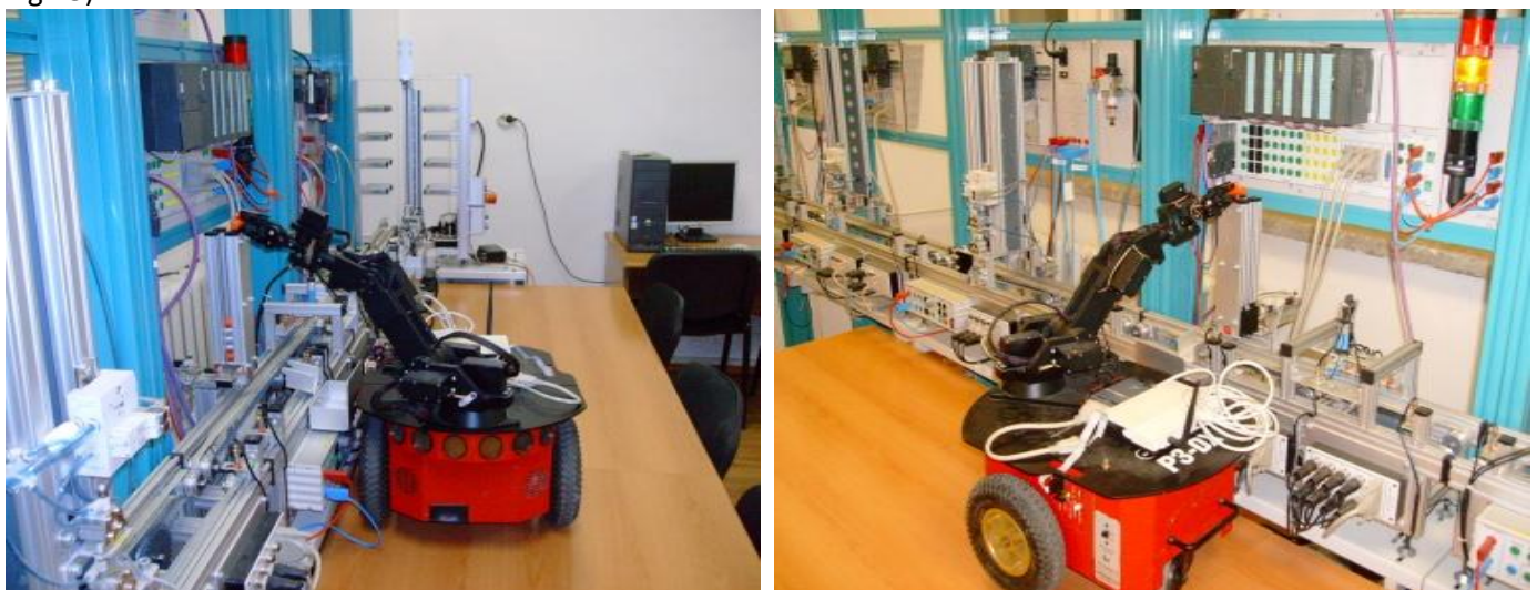
Fig. 5. Linia de mecatronica Hera&Horstmann deservită de robotul mobil Pioneer 3-DX echipat cu manipulatorul Pioneer 5-DOF Arm
