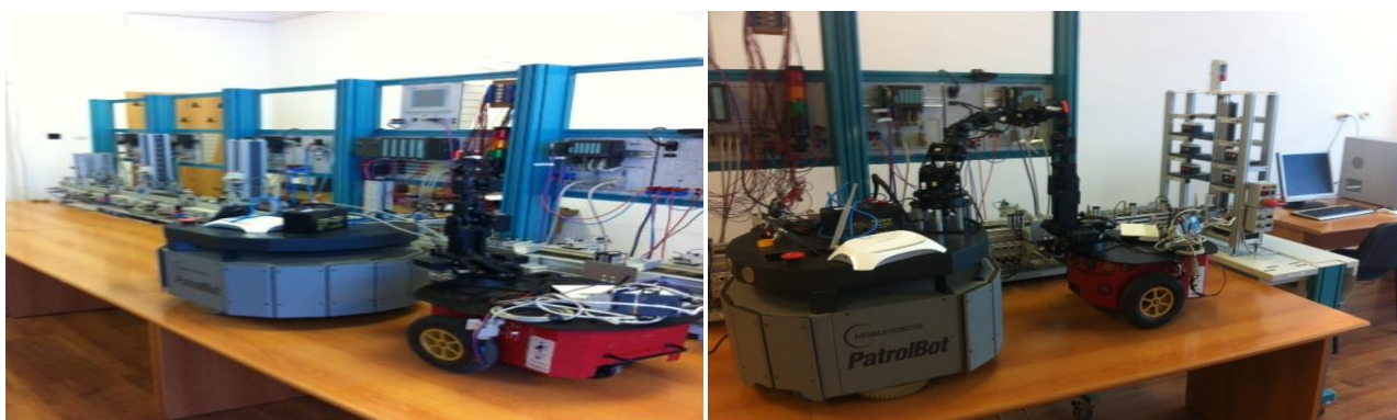
Fig. 32. Linia de mecatronics Hera&Horstman deservita de platformele mobile: Pioneer 3-DX (echipata cu manipulatorul Pioneer) si PatrolBot, aceasta neechipata sau echipata cu manipulatorul 6-DOF Cyton 2 Premium P-Series Robot Arm
