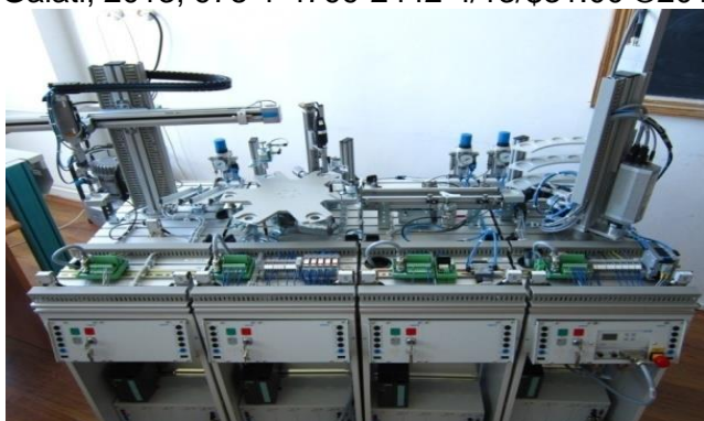
Fig. 11. Linia FESTO MPS-200 deservita de robotul mobil Pioneer 3-DX echipat cu manipulator
