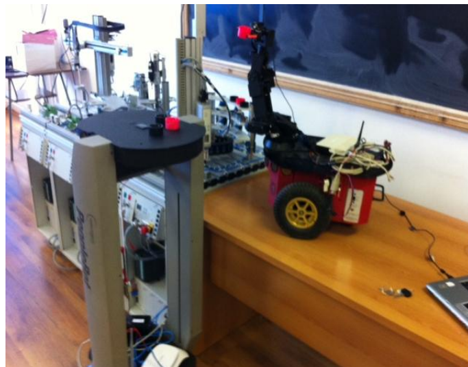
Fig. 17. Linia de mecatronica Festo MPS-200 deservita de două platforme mobile
